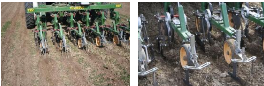
Foto 3-4. Såbedsharve til strip tillage teknik er baseret på TRV-radrenser fra Thyregod. Til venstre ses 2011-udgaven og til højre 2012-udgaven, hvor Germinator-harvetænderne er blevet skiftet ud med gødningstænder og sidepladerne er ændret for at lette passagen af jord. Målet er at opnå et ensartet såbed i rækken, mens jorden mellem rækkerne ikke bearbejdes for at spare.
