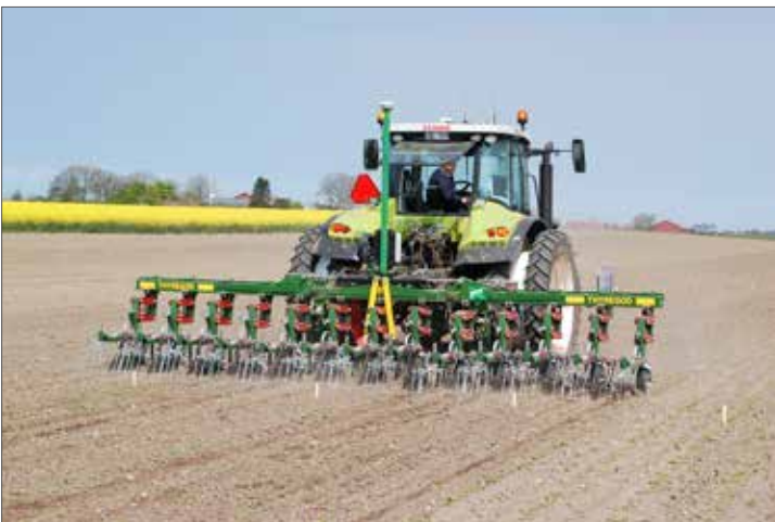
Bild 1. I steg ett såddes betorna med en konventionell 12-radig betsättare utrustad med GPS-RTK-antenn på såmaskinen. Radrensaren, en ny 12-radig Thyregod, kunde via sin styrram styras med signal från GPS-RTK-antennen eller kameran som båda satt monterade på maskinen. Byte av system skedde enkelt genom omställning av två oljeventiler och byte av två oljeslangar.
