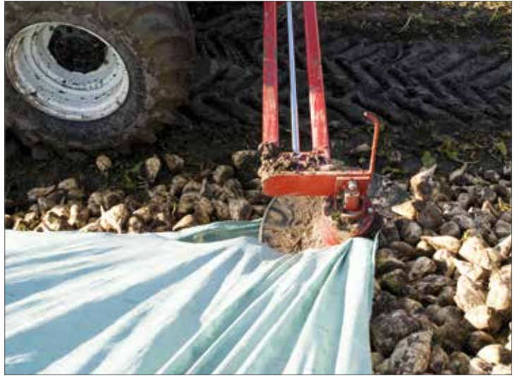
Bild 2: TopTexen trycks fast i nederkant med en roterande tallrik monterad i frontlyften på traktorn.
