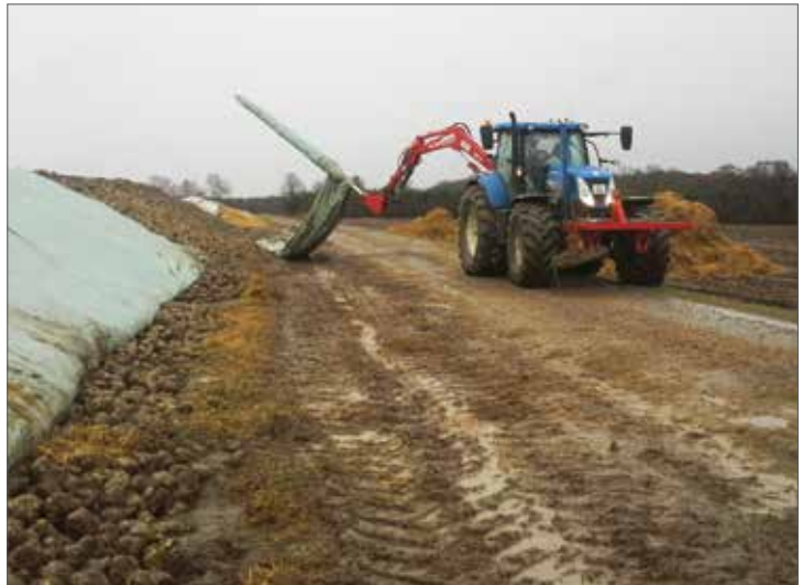
Bild 3: Maskinell avtäckning av en av årets försöksstukor. Duken rullas enkelt upp på den roterande metallstången och kräver ingen ytterligare hantering innan den stoppas tillbaka i containern.
