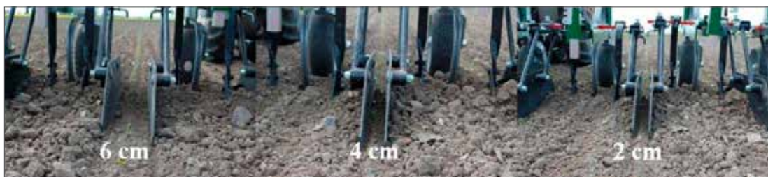
Figur 2. Bilden visar radrensarens inställning i de olika leden. Inställningarna var 2, 4 och 6 cm ifrån raden, dvs. plåtarnas avstånd till varandra var 4, 8 respektive 12 cm.
