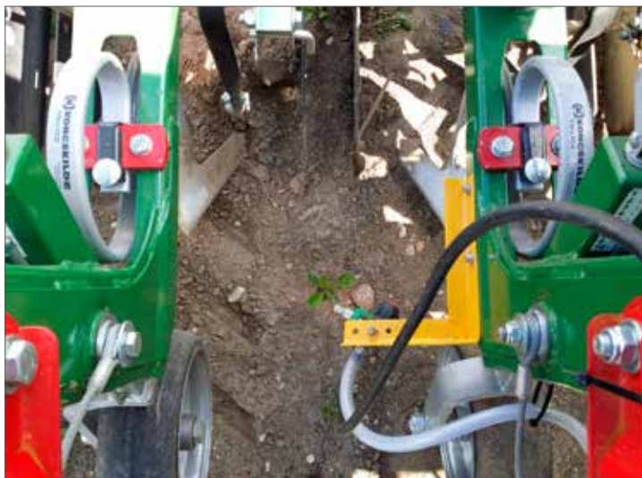
Luftassisterat AirTech-munstycke monterat på radrensaraggregatet och vinklat för att uppnå 12 cm appliceringsbredd.
