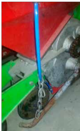
Startgödslingen placeras precis bakom fröhjulet. Se den blå slangen på bilden.
