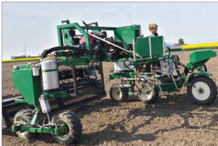
Parcellspruta med åtta ramper samt autostyrning med RTK-GPS-precision. I framkanten syns även grödsensorn OptRx som testats som verktyg inom fältförsöken.
