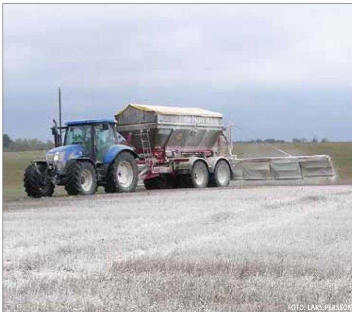
Spridning av kalkstensmjöl med en rörspridare.
