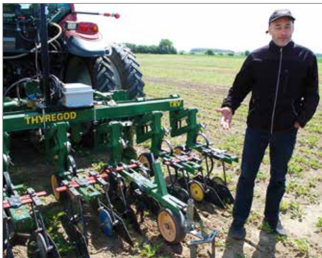
I fält fick vi också tillfälle att se radrensning med GPS/RTK-styrning i aktion. Otto visade även strip tillage-modulen för vårens såbäddsberedning i aktion.
