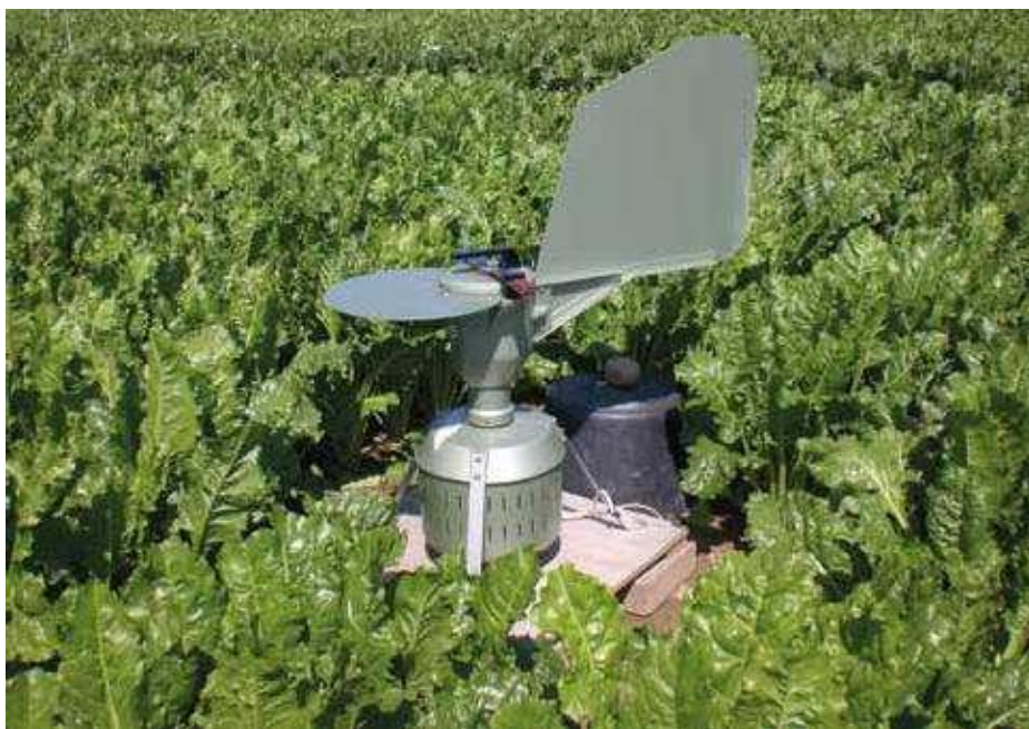
Foto 1. Burkard sporefælde opstillet i forsøgsmark. Luft suges ind på et stykke tape, hvorpå luftens partikler fæstnes.
