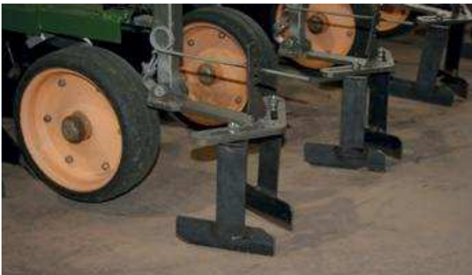
Foto 5. Monteres denne enhed bagerst på den ombyggede TRV-radrenser laves en lille vold, hvori afgrøden sås.
