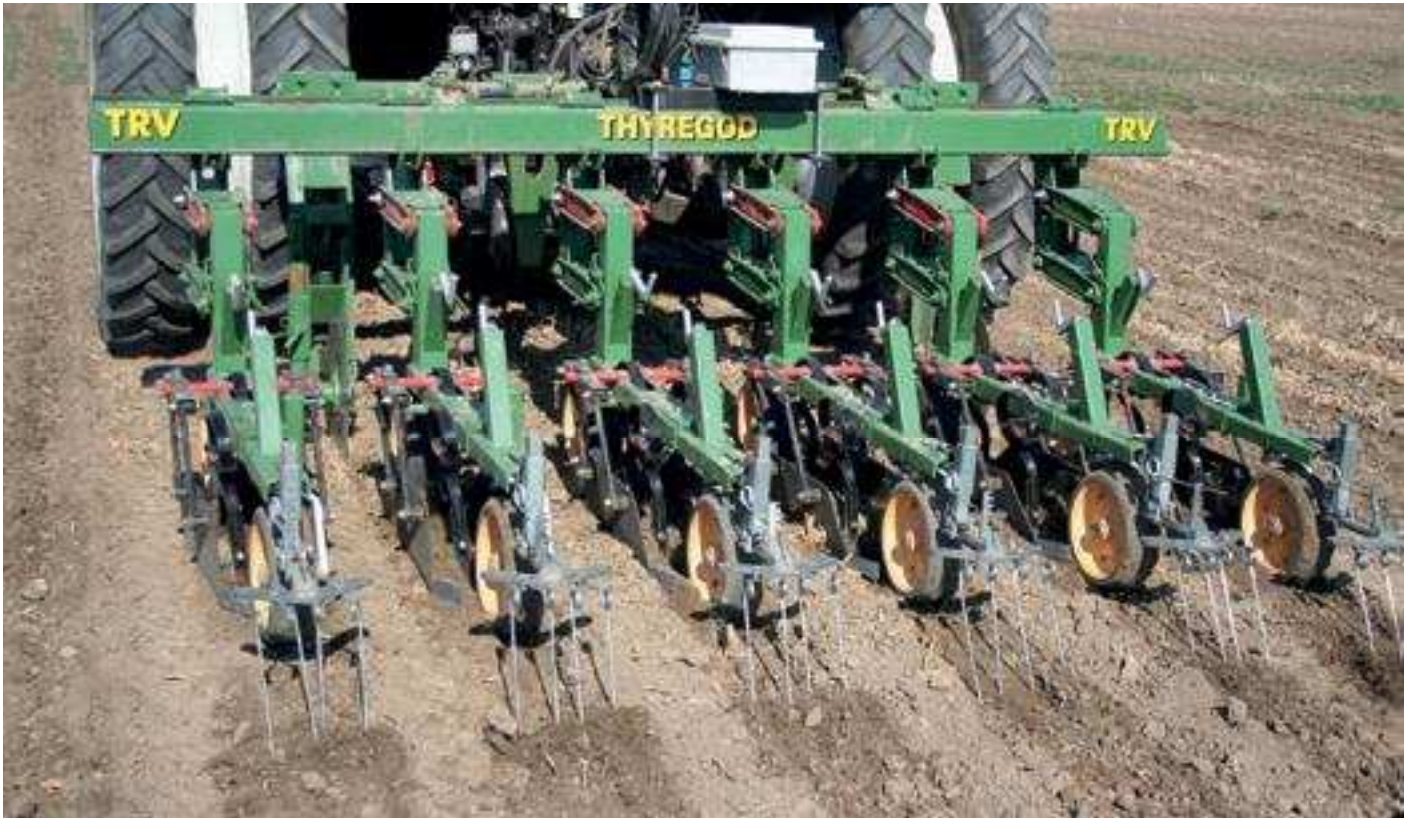
Billede 2. Thyregods TRV-radrenser er ombygget til rækkebaseret (strip-tillage) såbedsharve ved at montere et ekstra hjul bagerst samt ved at erstatte radrensertanden med tre såbedsharvetænder.
