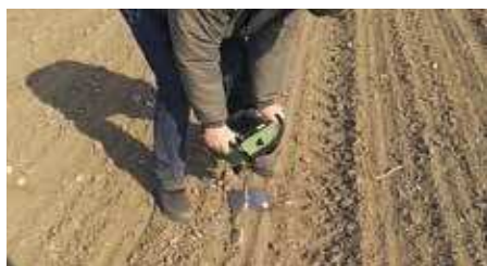
Foto 2. Med hjælp af et penetrometer er jordmodstand blevet målt i alle parceller.
