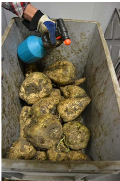
Figur 5. De betor som skulle vara fuktiga under försöket sprejades med vatten innan och efter behandling. Foto: Johan Skyggeson.
