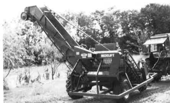
Bedelift upptagare Enligt Statens maskinprovningar endast hälften spill mot övriga provade maskiner
