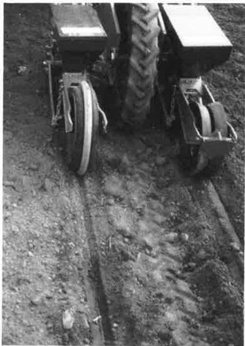
Såmaskin utrustad med normal Monocentra-tryckrulle och Loman-tryckrulle. Lägg märke till skillnaden i såbäddsprofil.
