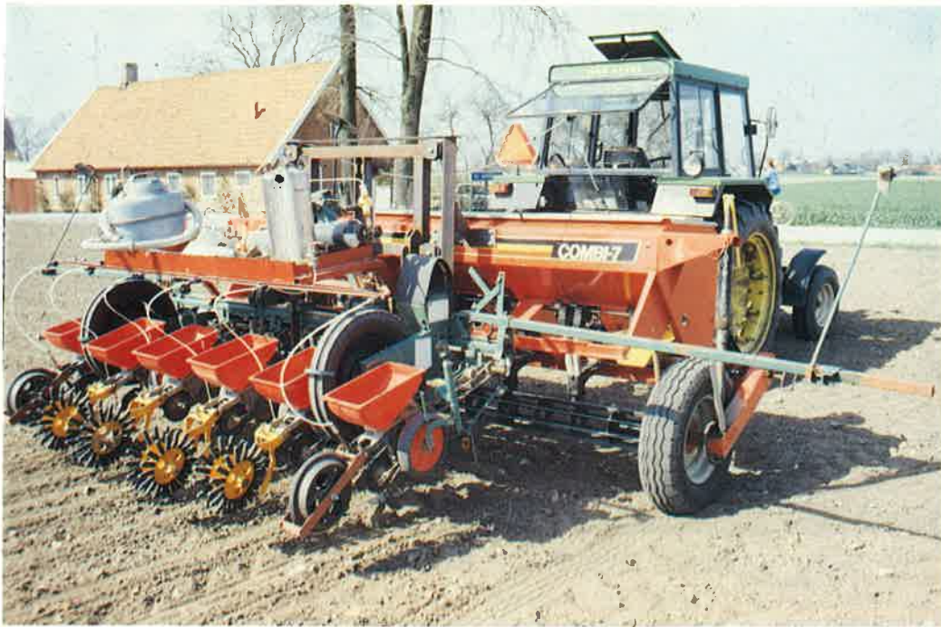
Sådd av odlingssystemförsök -89. Här är betsåmaskinen ihopkopplad med en Tume radmyllningsmaskin.
