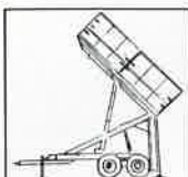
12 tons högtipp, tipp-höjd 2400. 3-vägstipp. Broms 2 axlar. Rymd 15 m 3 . Rotfruktslämmar
