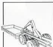
Växlarvagn med självstyrande boggie. Rullflak av Europastand.
