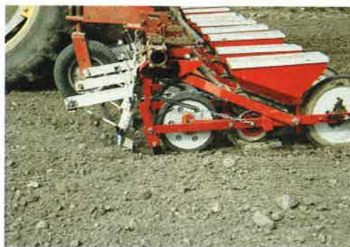
Gödselbill för flytande gödsel monterad på en 10-radig Tume. Billen sitter mellan förplog och första farmflexhjulet.
