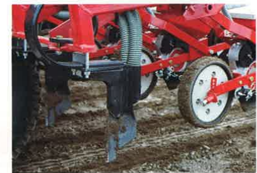
Gödselbill på Tumes pneumatiska radmyllare.
