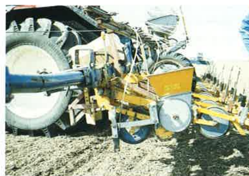
Gödselbill för flytande gödsel monterad på en 12-radig Unicorn II. Billen sitter i framkant av farmflexhjulet.
