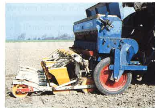
Ombyggt Saxoniasåmaskin för myllning av fast gödsel till sockerbetor, 6 rader.
