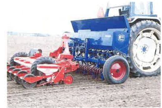
Radmyllare från Fiona, Danmark, 6 rader.
