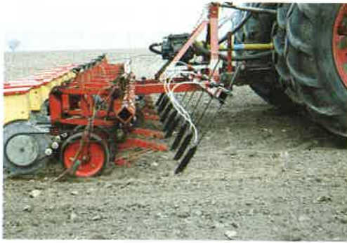
Gödselbilar för flytande gödsel monterade på en extra balk på en 9-radig Palm.
