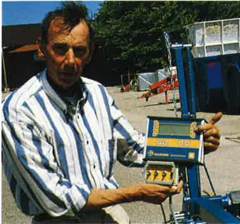
Unicorn-såmaskinens "hjärna" – den elektroniska styrenheten.
