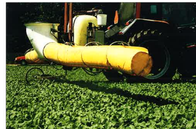
Kyndestoft luftutrustning var monterad på en Hardi-spruta.
