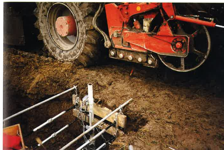
Marktryck och markens rörelse när den överfars av hjul registreras med hjälp av sonder, instuckna horisontellt från en grop.
