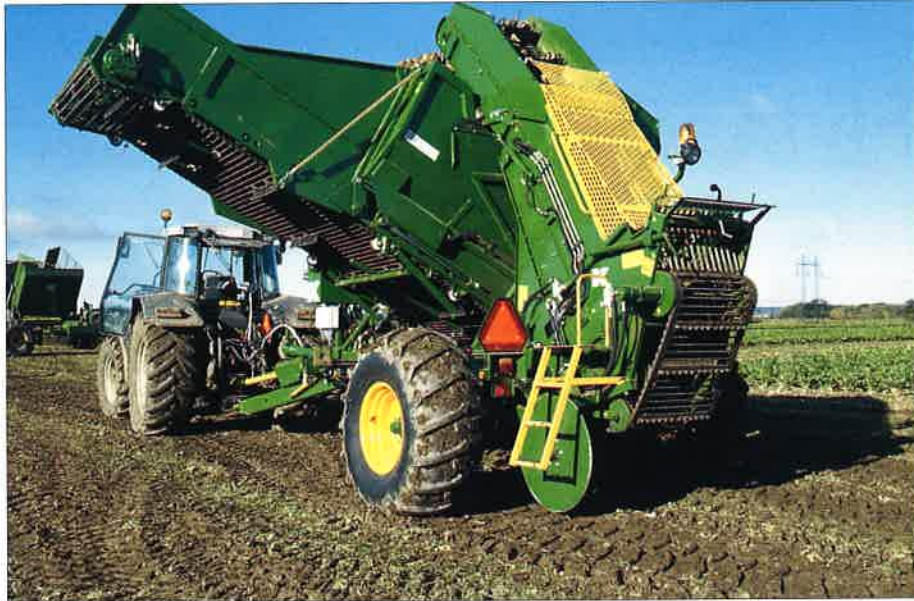
Thyregod med borste och rensellevator har bäst stenfrånskiljningsförmåga i testerna.
