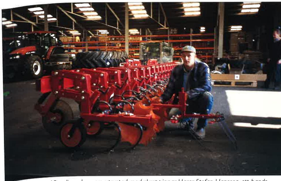
Med en 18-radig radrensare utrustad med skrappinnor klarar Stefan Hansson att bandspruta ett 16 cm brett band.
