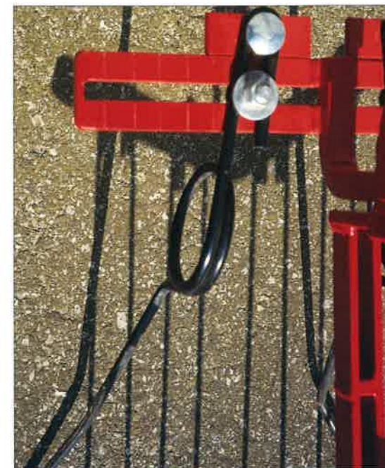
Stefan har gjort markeringar på fästet för att enklare ställa in alla sektionerna.
