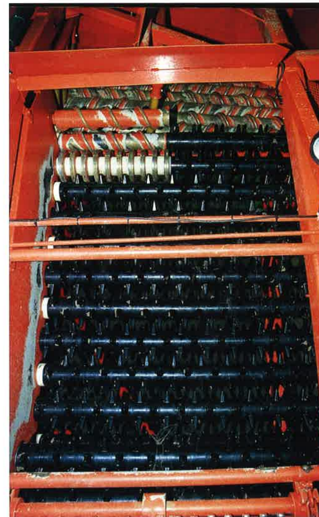
Gebo Holmers nya breddade och sluttande rensbord med spiralvalsar på det tvärgående bordet.
