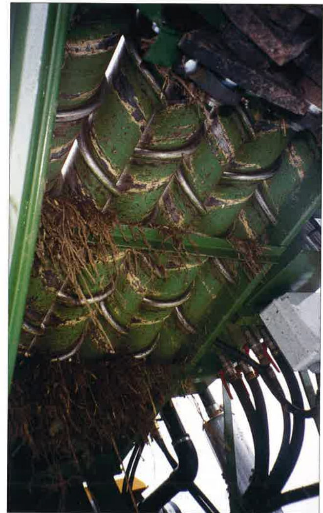
Thyregods spiralvalsar rensar effektivt bort ogräs, halm och lera.
