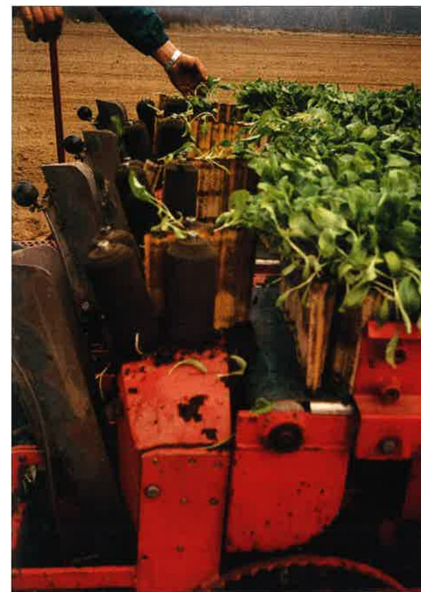
En av årets demonstrationsodlingar i KRAV-sockerbetor: plantering av sockerbetsplantor i hopklistrade cigarrformade paperpots där 700 plantor hänger ihop fram till planteringsögonblicket då de dras isär av ett par rullar och släpps ner i planteringsfåran.
