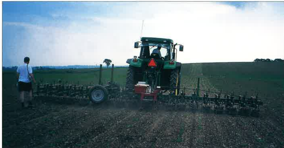
I 8-radig radrensare från Moteska utrustad med bildanalysstyrning. För att ge tillräcklig kraft att styra är radrensaren utrustad med dubbla styrskivor.
