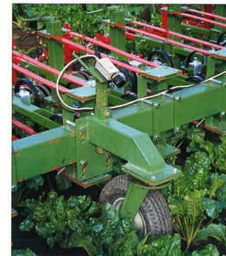
En kamera registrerar ett område framför radrensaren som är cirka en meter brett och fyra meter långt.
