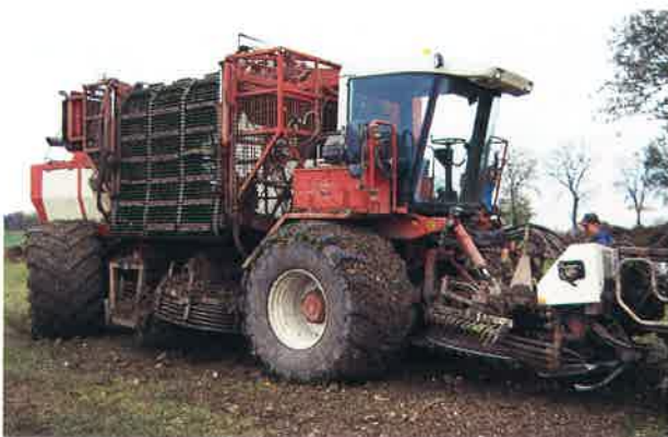
Det låga däckstrycket är viktigt för att minska packningsrisken. Sten Segerslätt har det senaste i däcksväg på sin Riecam, MEGA X BIB, 1050 mm breda Michelin radialdäck där det är möjligt att köra med ringtryck runt 1,5 kg/cm 2 vid 8 tons hjullast.
