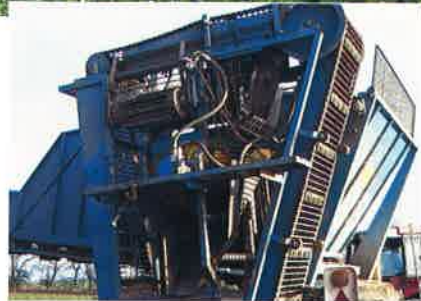
Edenhall arbetar med en ny elevator utrustad med stenfrånskiljningsutrustning. Den provades första gången på Övedskloster.
