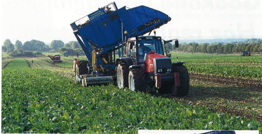
Edenhall arbetar med en ny elevator utrustad med stenfrånskiljningsutrustning. Den provades första gången på Övedskloster.
