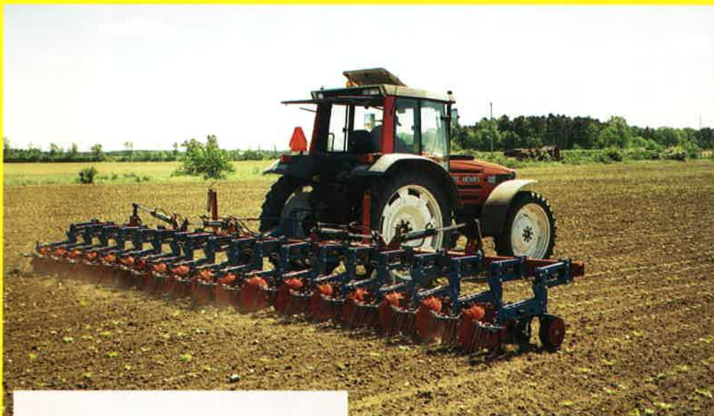
18-radig bakmonterad, hydraulisk uppfällning.
