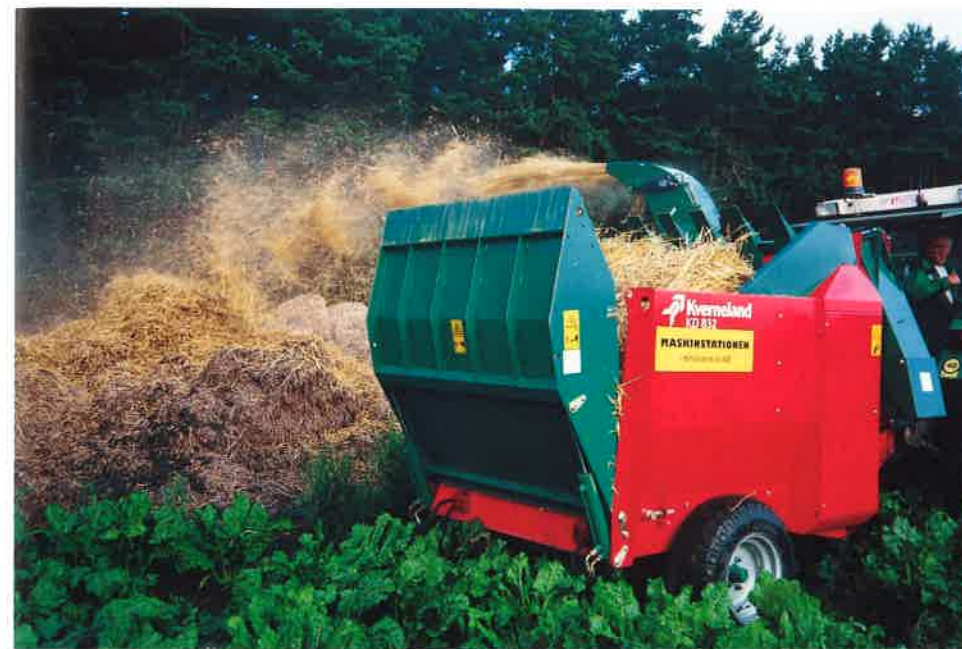
En ordinär trapetsstuka, max 2,5 m hög och med en flat topp som är cirka 1 m bred kan täckas helt maskinellt, inklusive toppen.
