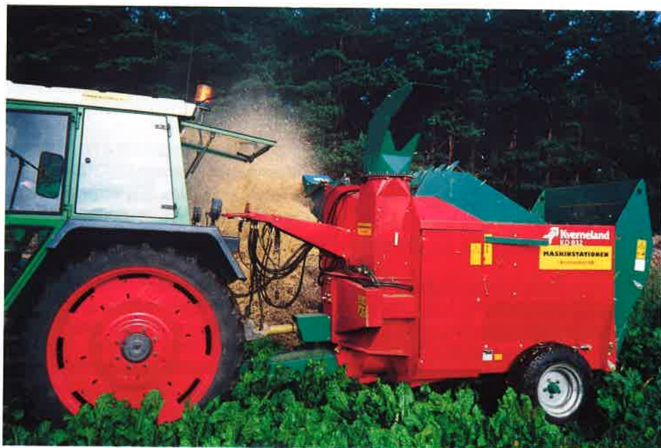
Halmrivaren kan sprida halmerna både till höger och vänster tack vare en egen modifiering. Ombyggnaden gör att maskinens utnyttjande väsentligt ökar.
