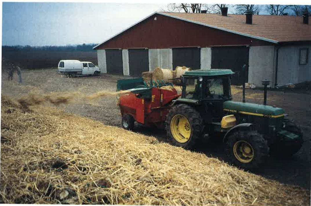
En effektiv halmrivare. 250 ton betor täcks med 20 cm halm på en timme.
