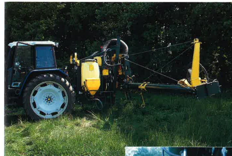
Danfoil använder sig av ett eget specialmunstycke. Därigenom använder de endast 30-60 liter vatten/ha vilket ger hög kapacitet.
