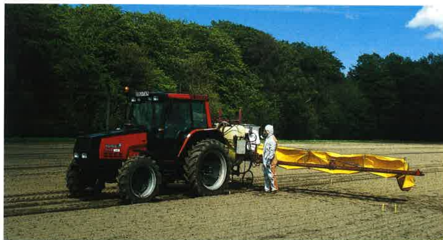
Kyndestofts luftteknik bygger på att luftströmmen bildar ett skydd bakom dropparna. I försöket gav 190 l vatten/ha bäst resultat för denna teknik.
