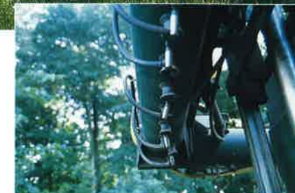
Danfoil använder sig av ett eget specialmunstycke. Därigenom använder de endast 30-60 liter vatten/ha vilket ger hög kapacitet.
