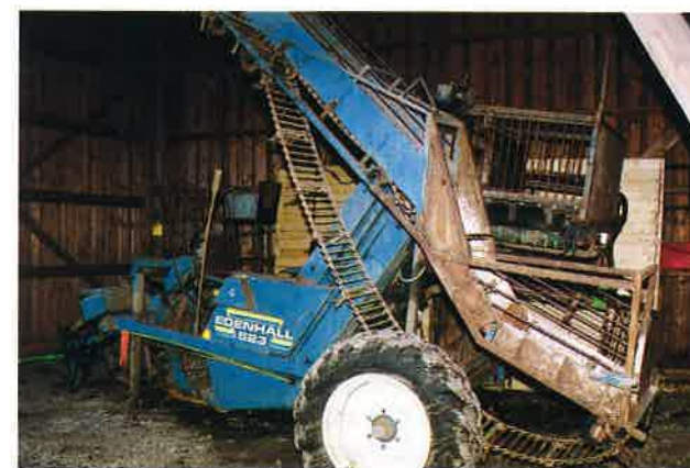
Den första maskinen Jonas byggde om, en Edenhall 523, visar tydliga spår av ombyggnad av bakkdelen och elevatortill följevagnen, för att få plats med stenfrånskiljningsutrustningen.
