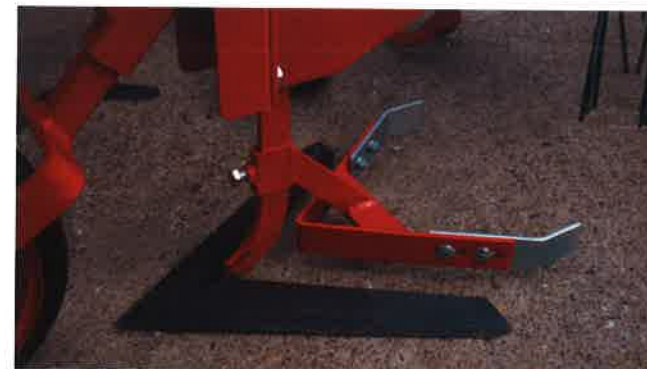
En stor gåsfoot, här utrustad med kuppningsutrustning, är vanlig i Holland.
