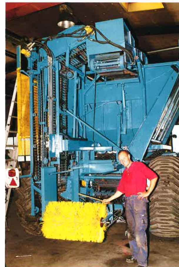
Inför årets säsong byggs stenfrånskiljningsutrustningen in i en Edenhall 733. För att få plats med utrustningen har den stående tankelevatoren vänts 90 grader. För säkerhets skull monteras en borste som skall föra tillbaka eventuella spillbetor till tankelevatoren. På bilden har ännu inte själva scannern och fingerpaketet som skiljer ifrån stenen kommit på plats.
