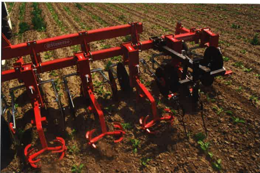
En så kallad krümmer är vanlig på radrensare i Holland. Den svenska skrapplinnen (torsion weeder) används också i viss omfattning.
