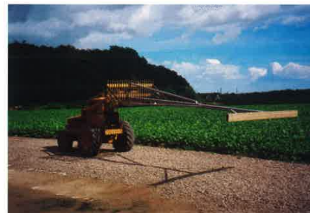
Exempel på utrustning för tilljämning av toppen på betupplaget.
