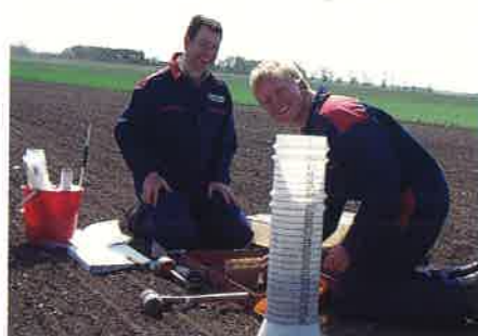
Såbädden. Så fort såmaskinen hade lämnat betfältet mätte vi bearbetningsdjup, undersökte aggregatfördelningen och tog prover på vattenhalt och porositet.
