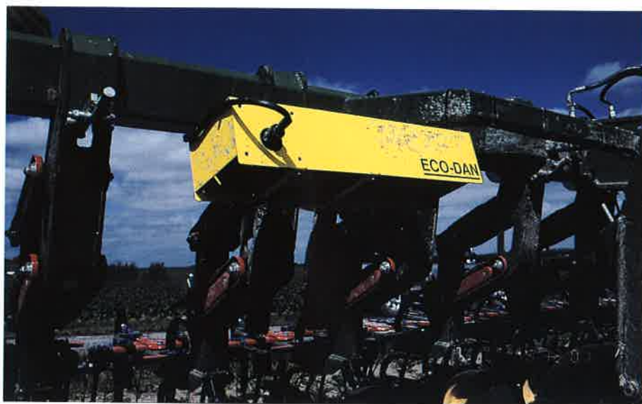
Optisk styrning från ECO-DAN. I den gula boxen sitter två kameror monterade som registrerar betraderna.
