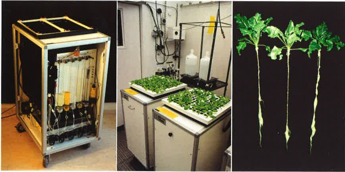
Bild 1. Sockerbetsplantorna odlas under kontrollerade förhållanden i klimatkammare och tillförs näring genom kontrollerad titring. I odlingsenheter (vänster) sprayas kontinuerligt näringslösning med mycket svag koncentration på plantornas rötter. De hänger fritt i luft i en rotbehållare som är åtskild från plantornas skott (mitt). Plantorna utvecklar fritt sitt rotsystem utan mekaniska hinder eller brist på lufttillförsel (höger).
