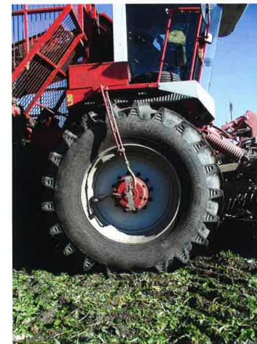
Tryckregleringsutrustning på tunga maskiner ger möjlighet att snabbt och enkelt justera ringtrycket efter förhållandena.
