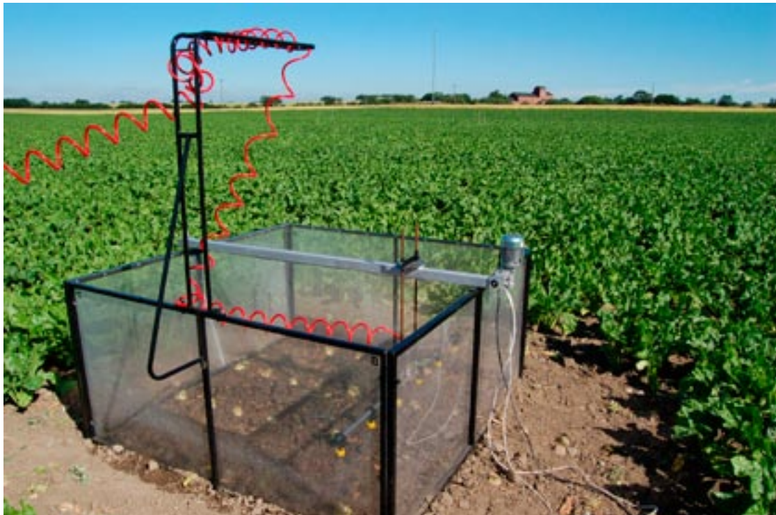
Bild 1. Utrustningen som användes för att applicera vatten och färg. En sprutbom med sex munstycken rör sig fram och tillbaka över området som ska infärgas.
