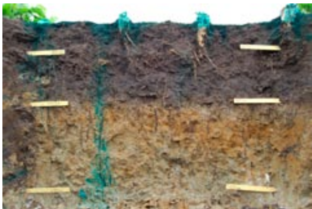
Bild 2. Infärgning med Brilliant Blue illustrerar vattnets rörelser i marken. Den blå färgen fastnar på de jordpartiklar som den kommer i kontakt med och på så vis kan man följa vattnets transportvägar i marken.
