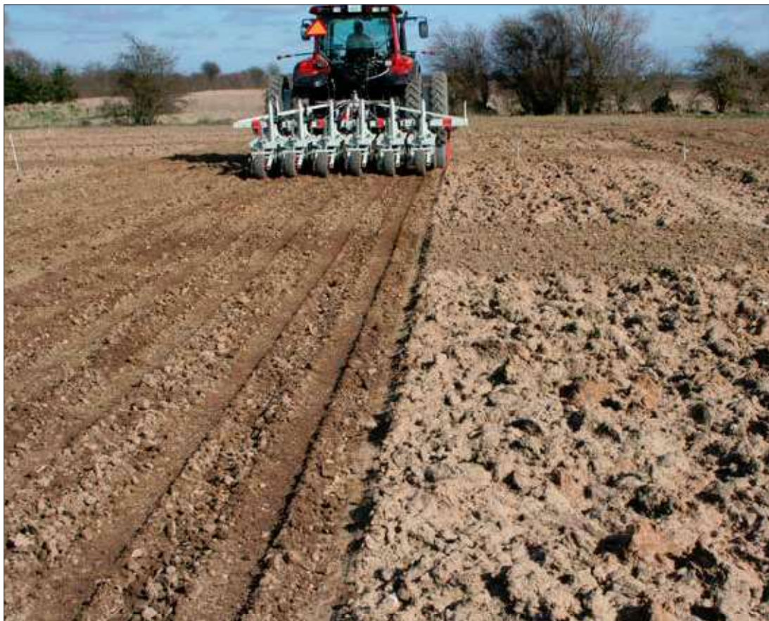
Här görs säbädden med en specialkonstruerad harv, som endast bearbetar jorden i raderna.
