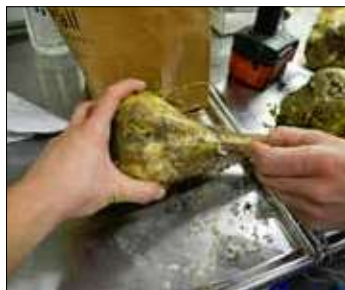
Här installeras temperaturloggrar inne i betan för att kunna studera hur lång tid det tar för betan att frysa.
