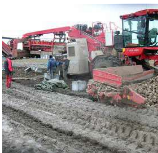
Försöksdagen den 10 december 2015. På den vänstra bilden syns presenningen som samlar upp betbitar och sten från rensverket på elevatoren.
