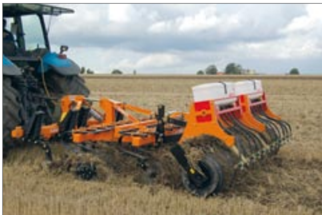
Bild 5. Sådd av vitsenap med Simba Express. Maskinen kombinerar djup bearbetning med kultivatorpinne med grundare bearbetning med tallrikar. Frösålådan sitter monterad bak på maskinen, ovanför packarvälten.
