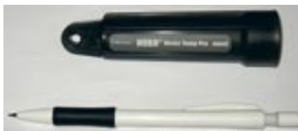
Bild 3. Enklare typ av logger med inbyggd temperaturgivare. Denna modell är vattentät och kan grävas ner för att mäta tex marktemperatur eller sänkas ner i ett rör i en betstuka.
