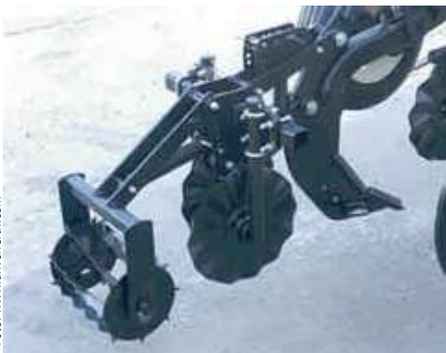
Foto 5. Rækkemodul til strip tillage fra amerikanske Unverferth.
