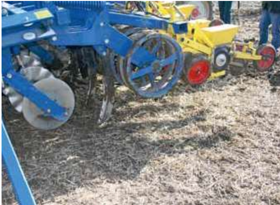
Foto 6. Köckerling har i samarbejde med Nordzucker og en sukkerroedyrker udviklet et redskab, hvor jordbearbejdning i rækken kombineres med såning.
