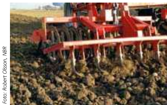
Foto 5. Albom II er frontmonteret og er konstrueret af Christian Wraghe med udgangspunkt i Albom I. Der er anvendt fræsertænder som harvetænder og disse efterfølges af pakkevalse og slæbeplanke (Pløjboy).
