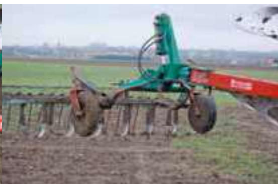
Foto 4. På Albom I anvendes fræserknive som harvetænder. Disse er robuste og slidstærke nok til at jævne pløjejorden. Derudover er der bagerst én række kraftige efterharvetænder.
