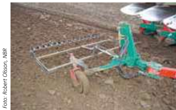
Foto 3. Albom I blev konstrueret i 2007 af Fondet for Forsøg med Sukkerroedyrkning og ses her i en nyere og kraftigere version påmonteret Kverneland plov.
