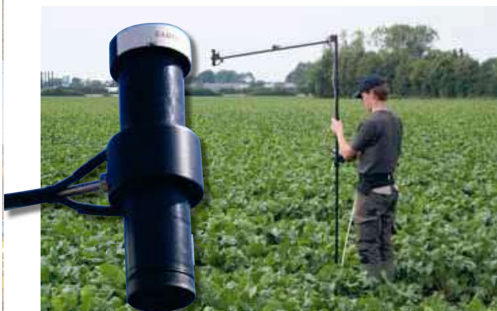
Foto 1. Ljussensorn som används till reflektansmätningarna i projektet.
