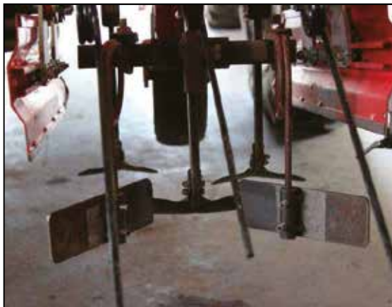
Foto 1-2. Foto fra årets forsøg. Sidepladerne er blevet løftet en smule så jord bliver skubbet ind i rækken. Foto til højre viser, hvordan hyppeplader er monteret på striglerne.
