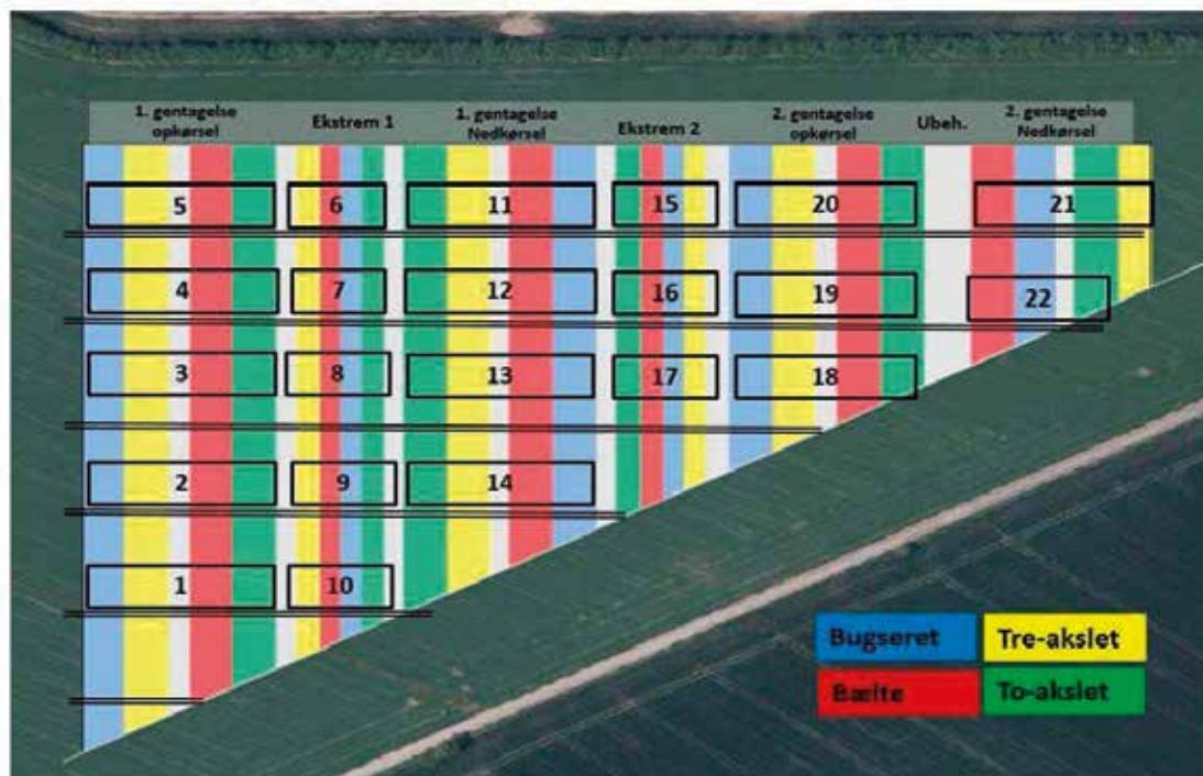
Figur 1: Skematisk tegning over forsøgsopbygningen. Farver angiver de enkelte roeoptagere. Blå = bugseret optager, Gul = Tre-akslet optager, Rød = Bælte-optager og Grøn = To-akslet optager. De Grå striber angiver roemarkens sprøjtespor. Øverst i billedet er vist hvilken gentagelse og retning optagerne har kørt i. De nummererede firkanter er de 22 observationsfelter, med fire optagertyper i hver (bortset fra felt 22, hvor der kun er 3 optagere). De sorte dobbelte striber markerer sprøjtespor i bygmarken. I de almindelige behandlinger har hver optager haft en arbejdsbredde på 12 m, og i de ekstreme behandlinger en arbejdsbredde på 6 meter.
