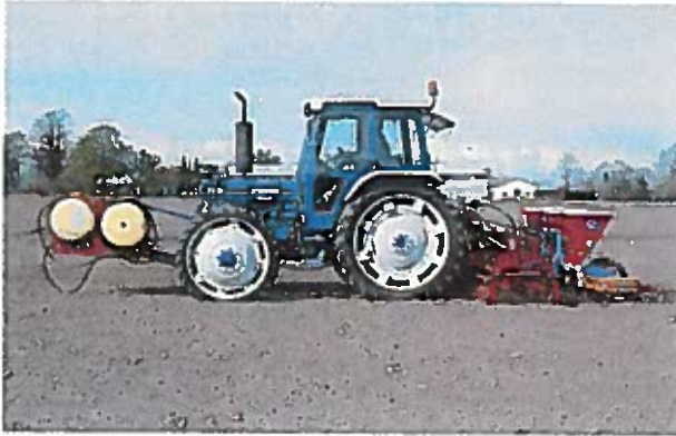
Forsøgsudstyr til placering af såvel flydende som fast gødning.
