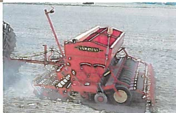
Kombination af såbedsharve, der sår korn og godning på samme tid. Godning udbragt på denne måde svarer i virkning til placeret. Der er her mulighed for at lave såbed og udbringe NPK og ren kogsalt (Na) i en arbejdsgang.
