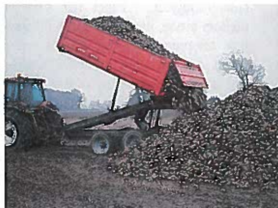
Høj bagtip giver mindst trafik på kulepladsen og en skånsom aflæsning
