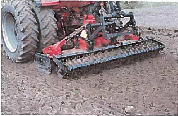
Tre meter Rotorharve Pagarano. (Det tager tid).
