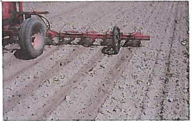
Ny dansk båndsprøjte fra Flemløse. Dobbeltdyser til hver række.
