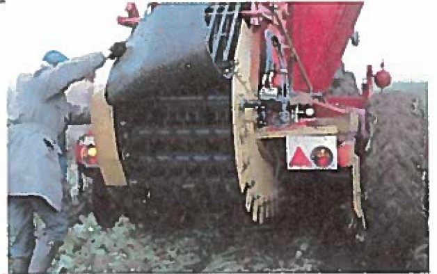
Nok en prototype med ekstra renseværk i elevatoren.
