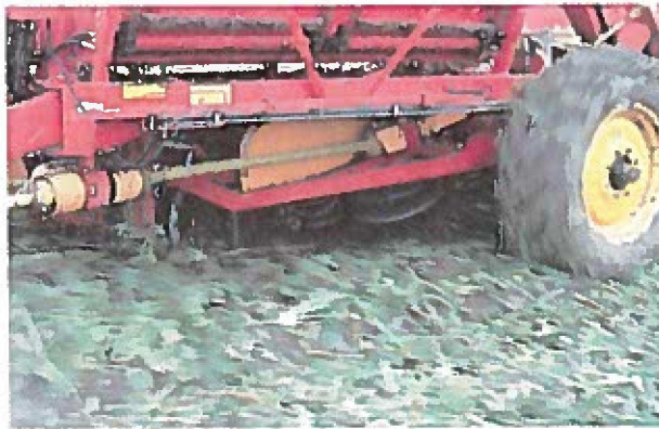
Bemærk nederst, de roterende tremmehjul, til at befordre roerne videre i rensævret.
