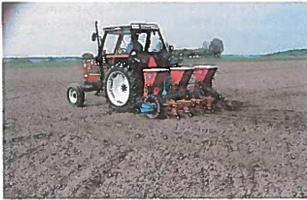
Såmaskine med udstyr til gødningsplacering.
