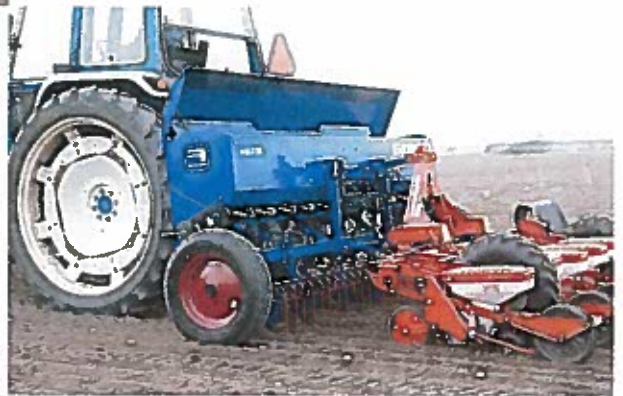
Placering af gødning med Fiona Rex gødningssåmaskine.
