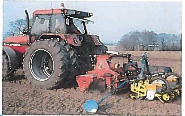
Såbedsharvning og såning på samme tid efterlader marken fuldstændig jævn.
