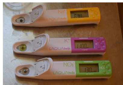
Foto 1. Laqua Twin-metre fås i forskellige udgaver. På billedet ses ionmålere for hhv. Kvælstof, Natrium, Kalium. NBR arbejder også på standardkurver for Natrium og Kalium.
