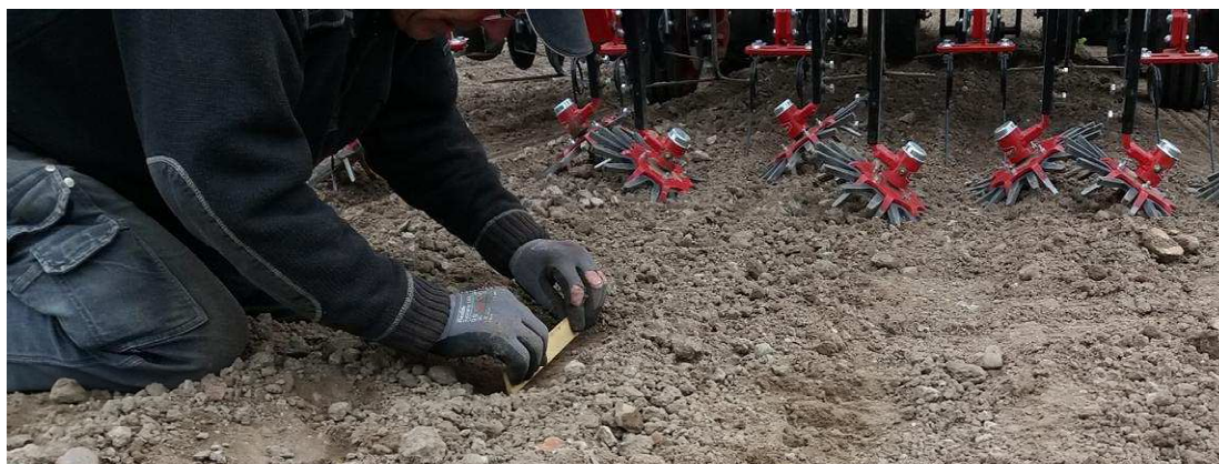
Foto 2. Blindstrigling med fingerrensere. Dybdeindstillingen kontrolleres.
