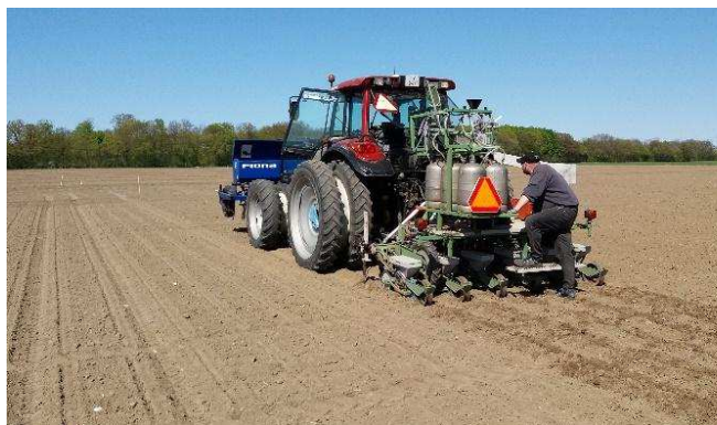
Foto 1. Gødninger blev placeret med gødningstænder fra enten frontmonteret Fiona Rex (pelleret hønsemøg) eller med tænder monteret på såmaskinen (N34) (t.v.).
