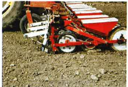
Gödselbill för flytande gödsel monterad på en 10-radig Tume. Billen sitter mellan förplog och första farmflexhjulet.
