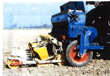
Ombyggd Saxoniasåmaskin för myllning av fast gödsel till sockerbetor, 6 rader.
