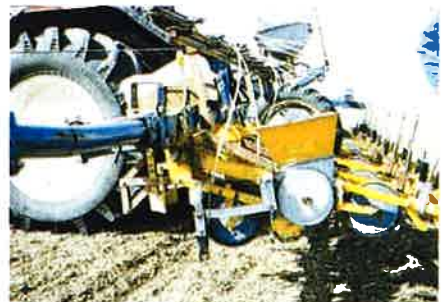
Gödselbill för flytande gödsel monterad på en 12-radig Unicorn II. Billen sitter i framkant av farmflexhjulet.
