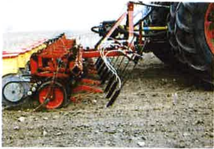
Gödselbillar för flytande gödsel monterade på en extra balk på en 9-radig Palm.
